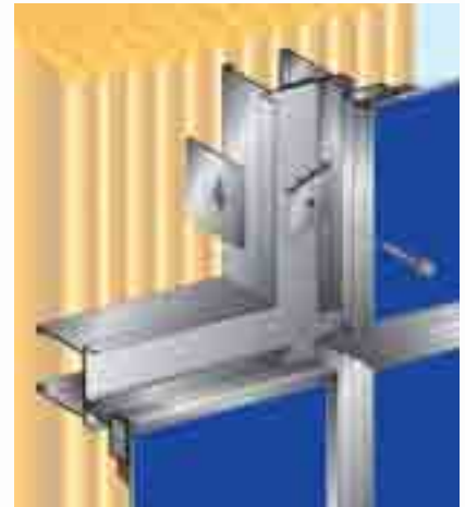
ALUCOBOND® Platten mit Rahmenprofilen eingefasst und verklebt.
